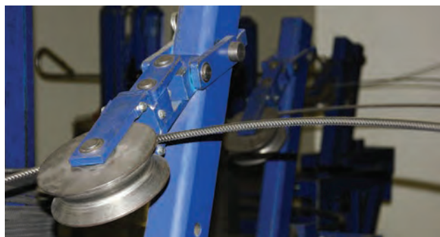
Umlenkrollen der Richtanlage
