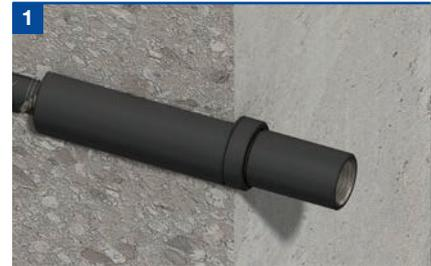
Der Betonstahl wird mit vormontiertem Hülseenteil der Kupplung auf die Baustelle geliefert und mittels Nagelteller an der Schalung fixiert. Beim Montieren muss darauf geachtet werden, dass das Gewinde nicht verletzt wird, oder Beton in den Hülseenteil eindringt. Nach dem Entfernen der Schalung und dem Öffnen des Hülseinteils wird der Anschlussstück mit der Kontermutter in den Hülseenteil eingeschraubt.
