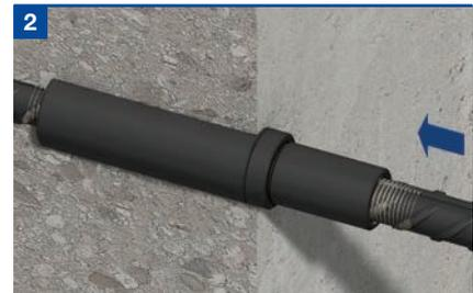
Nun wird der Anschlussstab in den Anschlussstück der Kupplung eingebracht. Dabei muss der Anschlussstab so nahe wie möglich an den einbetonierten Hülseenteil gebracht werden.
