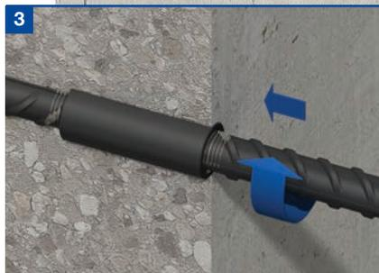
Den Anschlussstab bis zum Anschlag in die Kupplung einschrauben.
