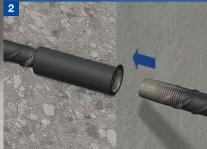
Nach dem Entfernen der Schalung und dem Öffnen der Kupplung wird der Anschlussstab in die Kupplung eingeschraubt.
