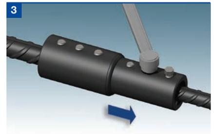
Die Scherbolzen auf der ersten Hälfte der Kupplung können nun, beginnend bei der Kupplungsmitte, und festgezogen werden. Verwenden Sie dafür eine Ratsche oder ein Schraubgerät. Es dürfen **keine Schlagschrauber** verwendet werden! In einem zweiten Durchgang müssen die Scherbolzen nun angezogen werden bis der Kopf bei der vordefinierten Sollbruchstelle abscherf.
