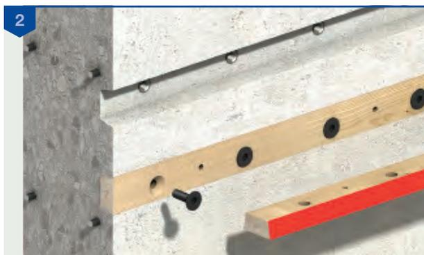
Die übrige Bewehrung ist jetzt nach den Angaben des Statikers einzubauen, die auf unseren Empfehlungen basieren. Danach wird der Beton eingebracht. Sobald er genügend Festigkeit erreicht hat, wird die Schalung entfernt und die Frontseite der Holzträgerleiste mit dem schützenden Klebestreifen freigelegt.
