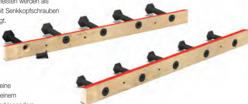
Keilförmige Holzleisten vereinfachen den Einbau, hinterlassen einen Wandanschlusschlitz und erhöhen damit die Verankerungstiefe
