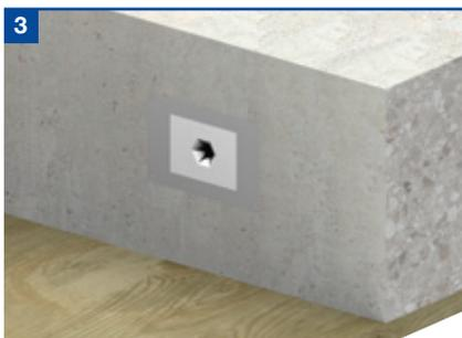
Nachdem der Beton eine ausreichende Festigkeit erreicht hat kann die Schalung entfernt werden. Nun kann der Aufkleber auf dem eingebauten Hülse teil entfernt oder durchstoßen, und der Dorn eingebracht werden. **Wichtig:** Bei der Verwendung von querbeweglichen Dornen (HLDQ oder ESDQ) sollte der Aufkleber immer mittig durchstoßen werden, sodass nur der zylindrische Hülse teil, der mittig in der Rechteckhülse sitzt, für den Dorn teil frei wird und der restliche Teil der Hülse geschützt bleibt.
